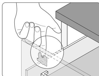
DE Sicherung entfernen
