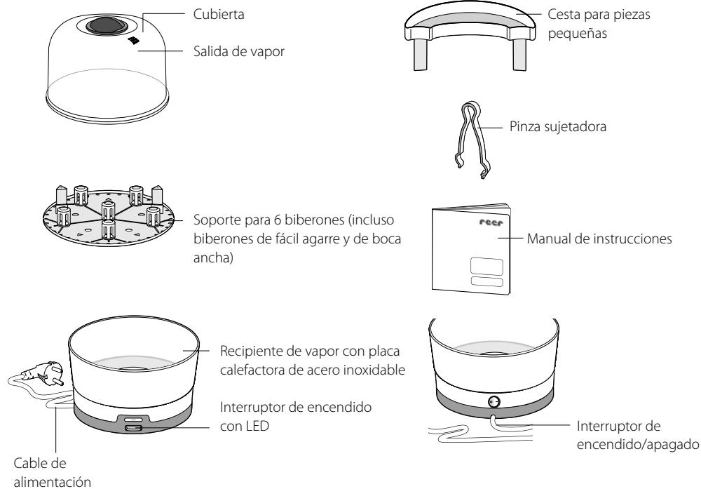
**Enjuague primero todos los elementos a desinfectar y elimine completamente todo residuo de alimentos. Coloque el biberón y el accesorio de forma que no estén en contacto con las paredes ni con la cubierta.**
